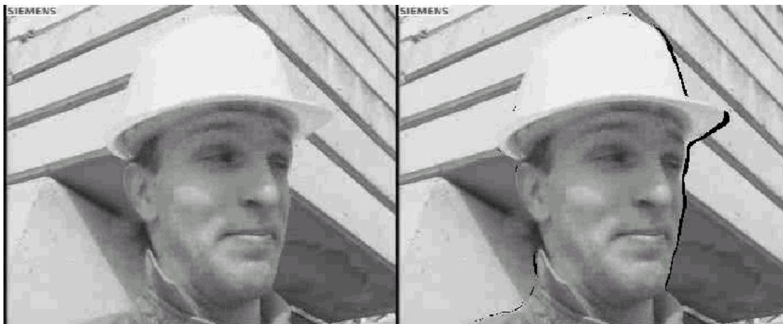
FIG. 2.9 – Illustration du problème de composition d'objet ayant des fréquences d'échantillonnage temporelles différentes. La figure de gauche illustre un codage-décodage de l'avant-plan et de l'arrière-plan à 30Hz. La figure de droite illustre le codage de l'arrière-plan avec un sous échantillonnage à 15Hz et l'avant-plan codé-décodé à 30Hz. Les figures sont extraites de [Lee et al. 03].
