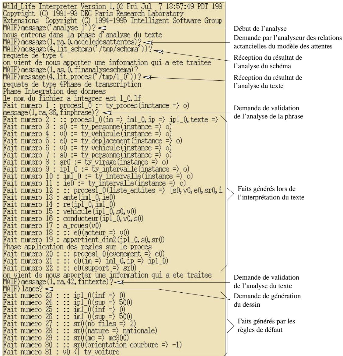
FIG. C.22 - Visualisation des tâches effectuées par le sous-système de construction de la scène
