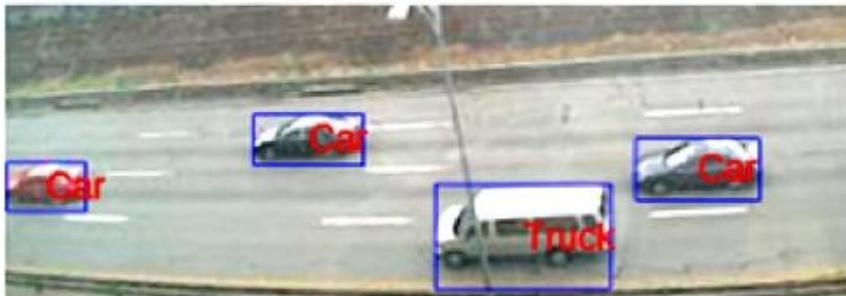
Détection de véhicule [Mader *et al.*, 2012].
