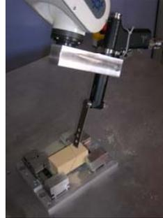
Fig. 3 : L'outil de coupe et sa fixation au robot
