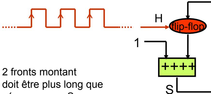
Le temps entre 2 fronts montant consécutifs doit être plus long que le temps de réponse pour  $S_3$
