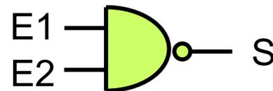
Si on force une des entrées à 1, on obtient un NOT
