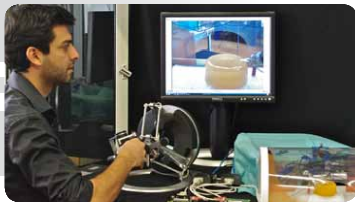
Robot SPRINT dédié à la chirurgie à port unique (conçu par la SSSA à Pise et contrôlé par le LIRMM) © Alonso Sanchez, LIRMM
