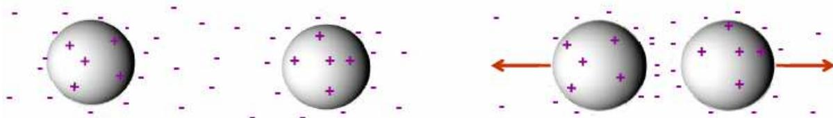
**Fig. 3. Représentation schématique de la répulsion électrostatique.**
