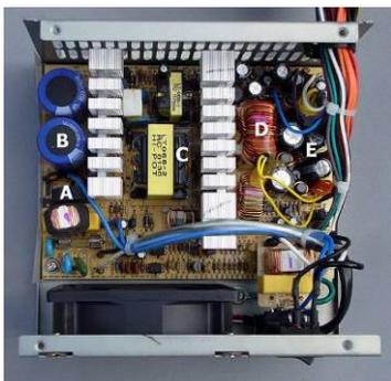
A pont de diode redresseur ; B condensateur du filtre d'entrée ; C transformateur d'isolement ; D inductance du filtre de sortie ; E condensateur du filtre de sortie
