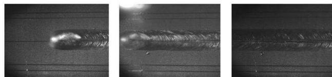
FIGURE 1 : Fissuration à chaud en soudage par faisceau d'électrons [7]
