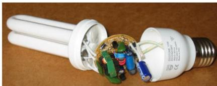
Figure 3 : Convertisseur à résonance pour tube fluo compact
