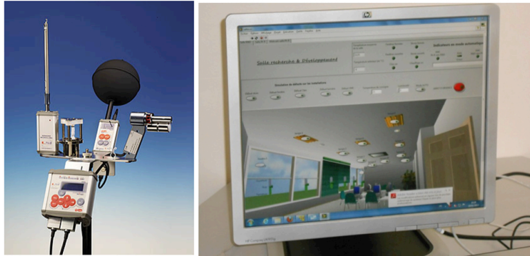
Figure 5 : Station de mesure du confort hygrothermique
