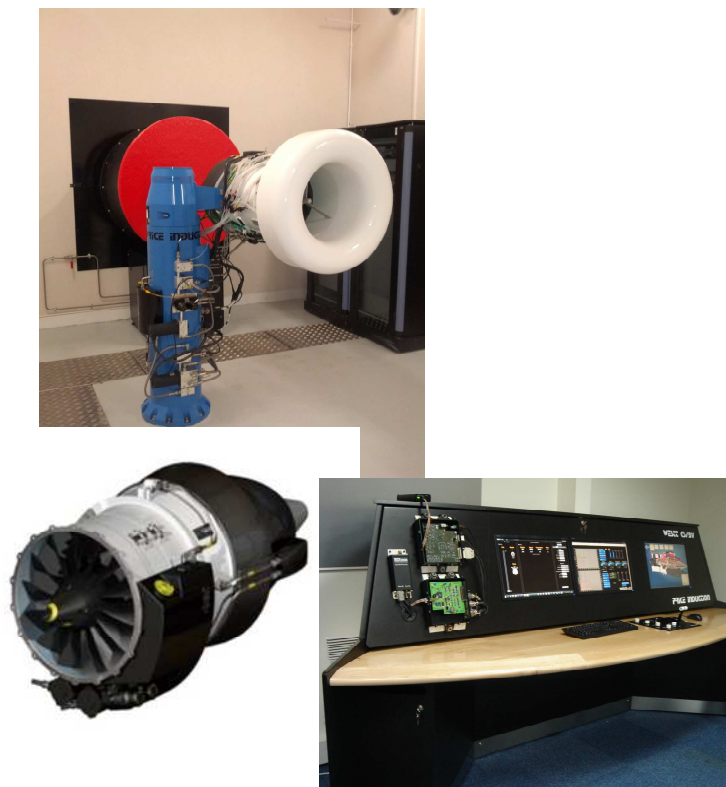
Figure 2 : La plateforme AEROfan fondée sur le moteur DGEN 380
