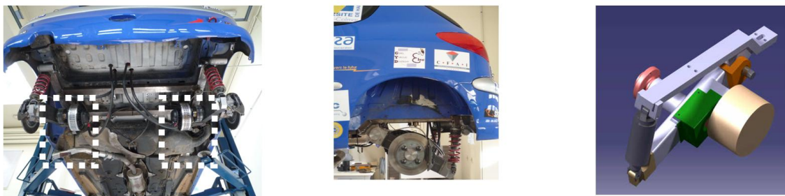
FIGURE 2 – Train arrière modifié pour le démonstrateur E 2
