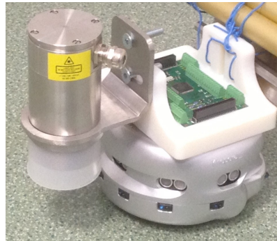
Figure 3 : Robot Khepera muni d'un pyromètre Laser
