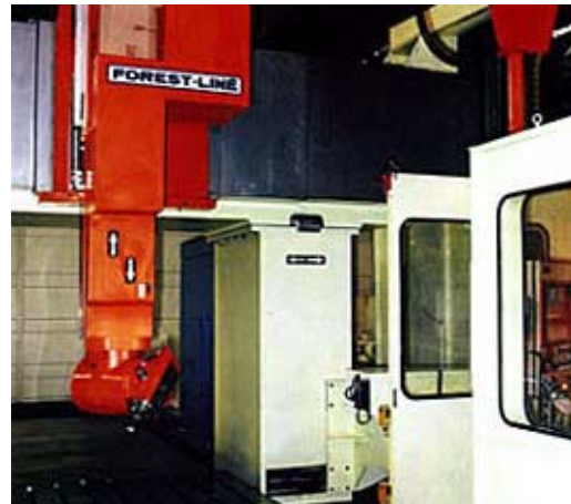
Figure IV-2 : Machine 5 axes type portique à structure cartésienne.
