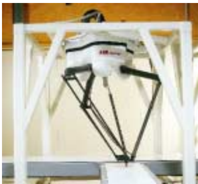
Figure I-17 : ABB FlexPicker - Robot Delta avec rotation de l'organe terminal.
