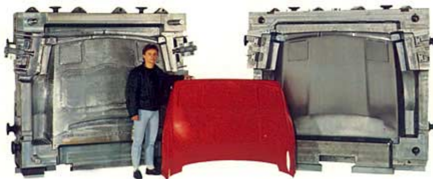
Figure I-3 : Matrice d'emboutissage avec surface gauche.
