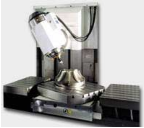
Figure I-6 : Centre d'usinage 5 axes à tête rotative 1 axe et plateau tournant.
