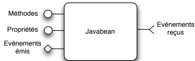
FIG. 2.9 : Structure d'un composant Javabean
