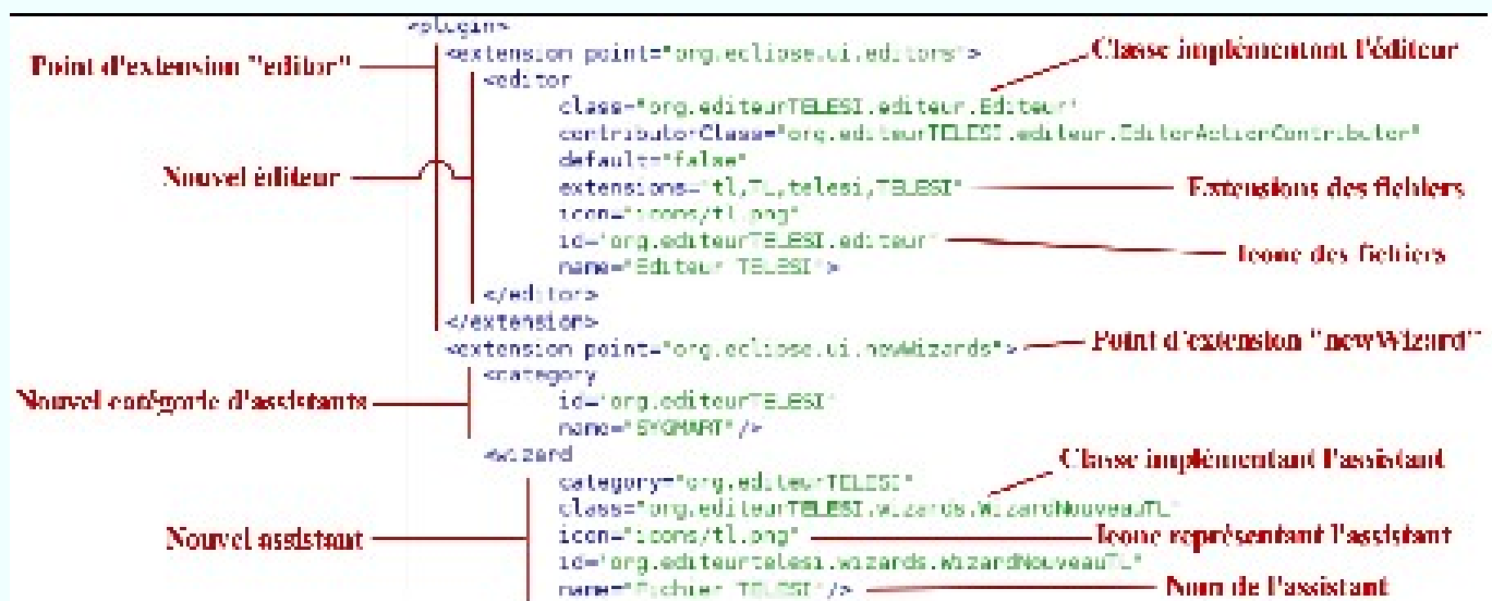
FIG. 5 – Exemple de configuration xml d'un plug-in
