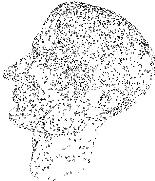
FIG. 2.14 – a) Maillage triangulé du visage (43039 points, 85145 triangles), b) Visualisation des quadrangles retenus (3313 quadrangles) pour un seuil de coplanarité S_c de 20^\circ .
