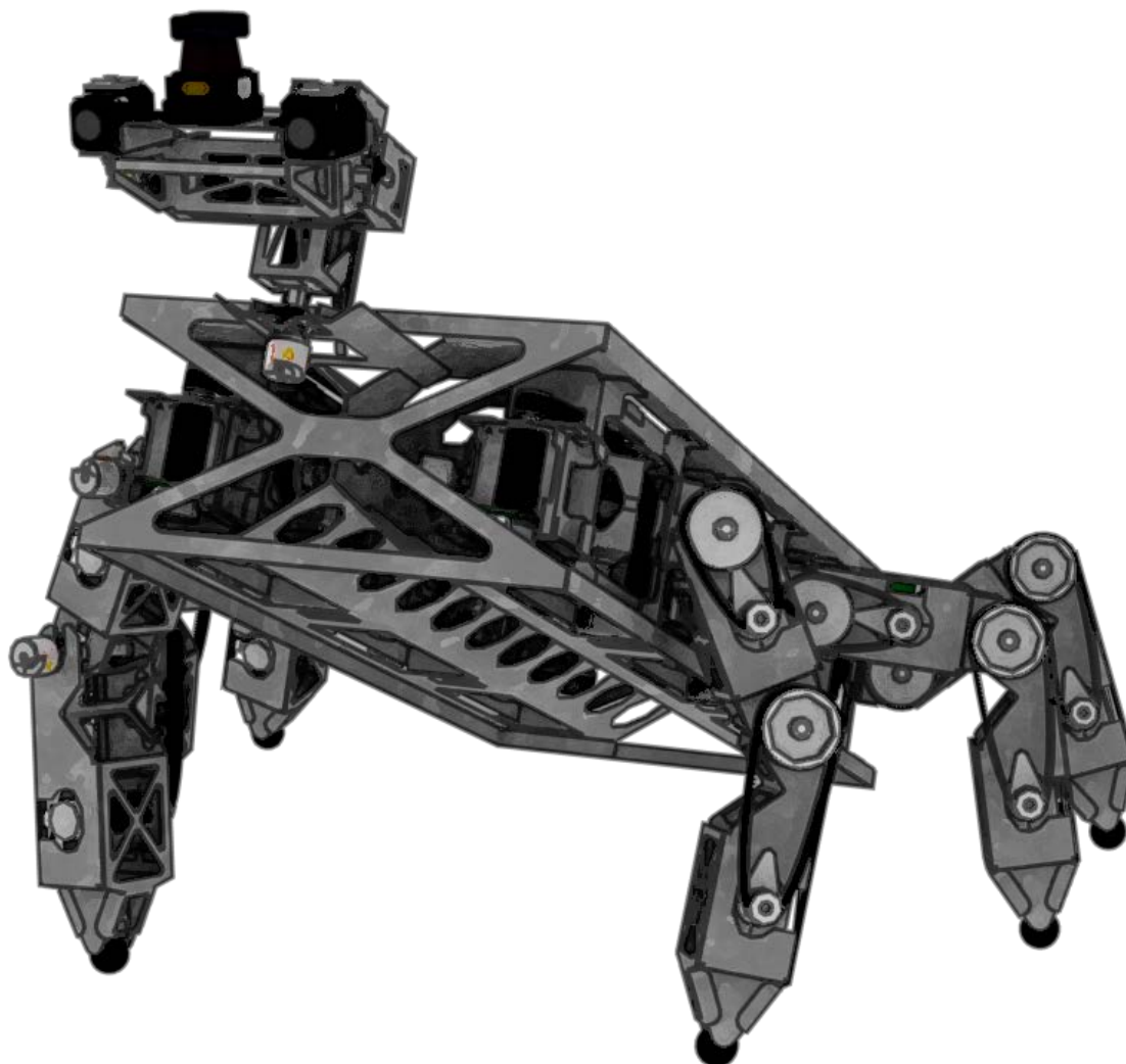
Figure 44 Illustration représentant le robot hexapode R.HEX
