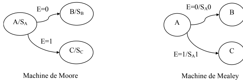
Figure 9.11. Structure des graphes d'état de Moore et de Mealy
