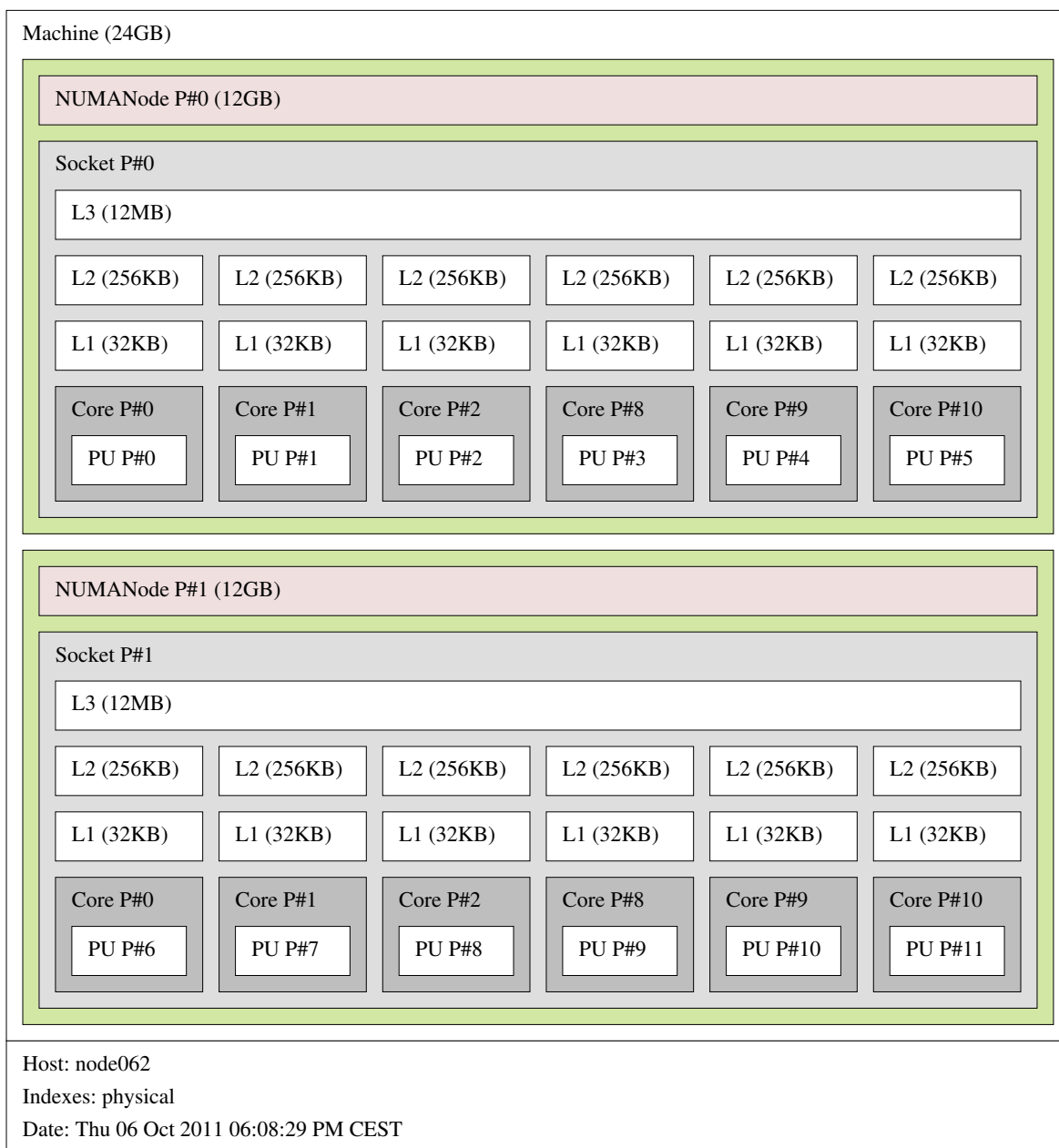
FIGURE 1.3 – Architecture d'un nœud de la plate-forme HPC@LR (deux processeurs Intel Xeon X5650)
