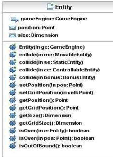
Figure III.E.1: la classe Entity avant factorisation comportant quatre méthodes collide ()
