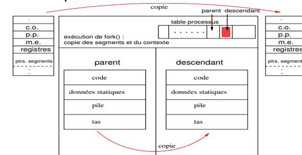
Avant la fin de *fork()* deux processus existent et tous les deux vont exécuter la fin de l'appel noyau, chacun dans son contexte. La pile de chacun contient un résultat différent de l'exécution de *fork()*. Donc chacun déroulera un cas différent de l'exécution du même code.
