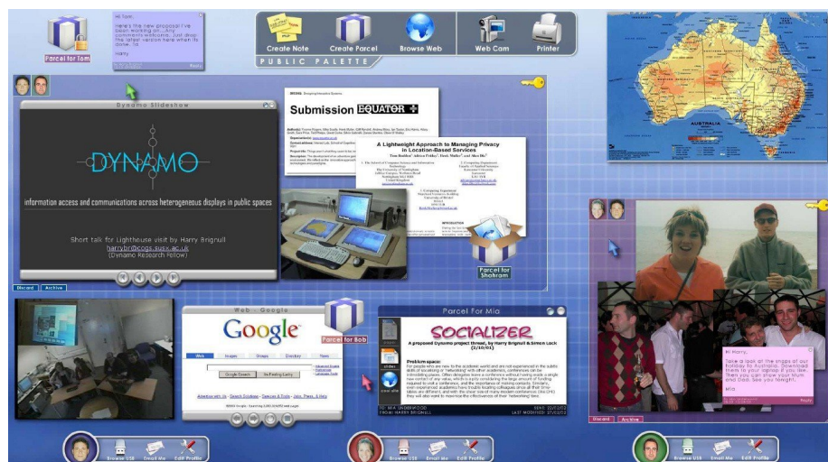
Fig. I.13: L'espace de partage de Dynamo : trois utilisateurs sont connectés sur le système (ils apparaissent dans la partie inférieure). Différentes applications sont lancées et deux zones de l'espace sont des sous espaces privés. Les icônes dans le coin supérieur gauche de chaque zone privée indiquent que le premier utilisateur peut accéder à la zone de gauche, le second à la zone de droite et le troisième aux deux zones [Izadi et al., 2003].
