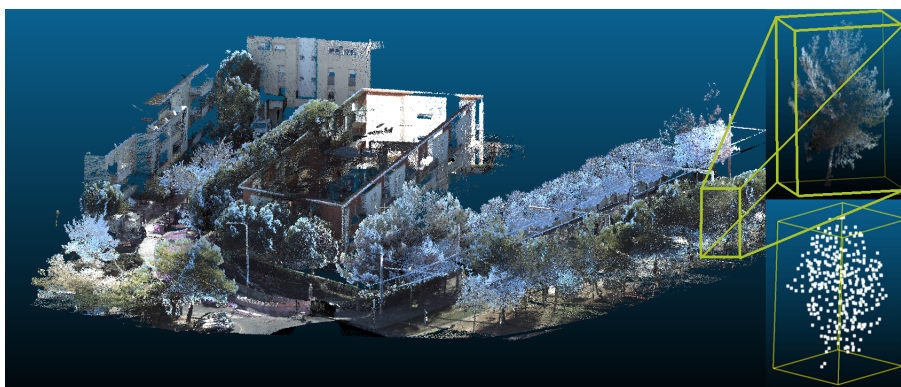
FIGURE 2 – Vue globale de notre acquisition LiDAR terrestre. On peut y distinguer des arbres, un arrêt de tramway ainsi qu'une petite résidence. A droite, un arbre est isolé puis sous échantillonné en un nuage de 512 points
