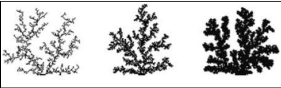
**Figure<sup>6</sup> 24 :** Influence de la viscosité sur la formation d'agrégat. Avec l'augmentation de la viscosité (de gauche à droite), les agrégats change de forme source : figure 1 article Christoph P.E Zollikofer
