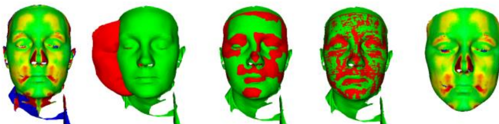
Fig. 8: Résultat des trois premières étapes du pipeline ; de gauche à droite : Cartographie de l'asymétrie individualisée sur la surface ; surface (en rouge) et modèle (en vert) avant recalage; surface et modèle après recalage rigide ? basé sur la similarité ; surface et recalage après recalage non linéaire; cartographie de l'asymétrie « normalisée » sur le modèle
