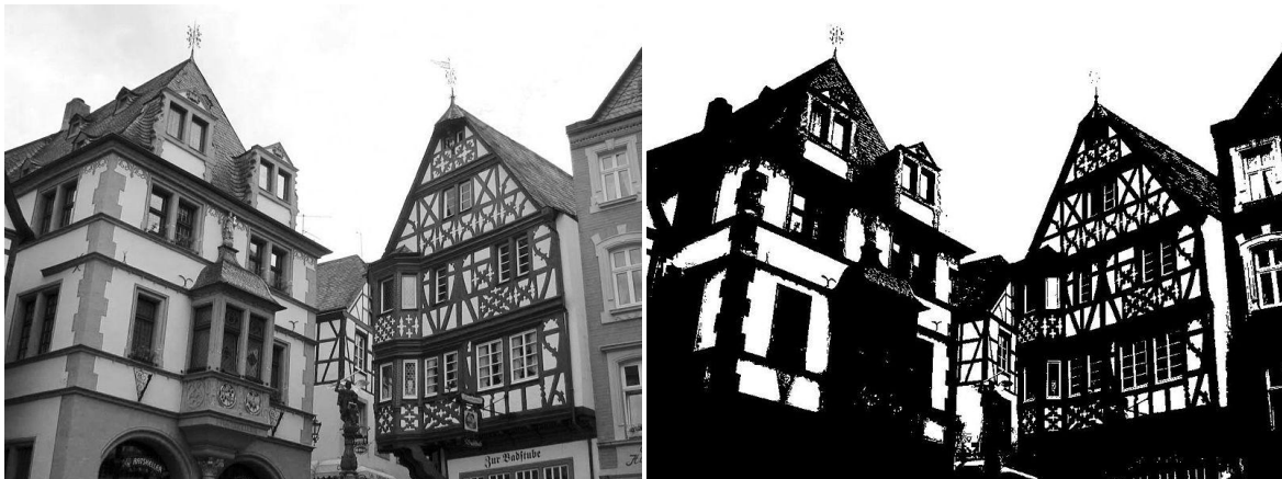
Figure 18 Image avant et après un seuillage via l'algorithme d'Otsu [h]
