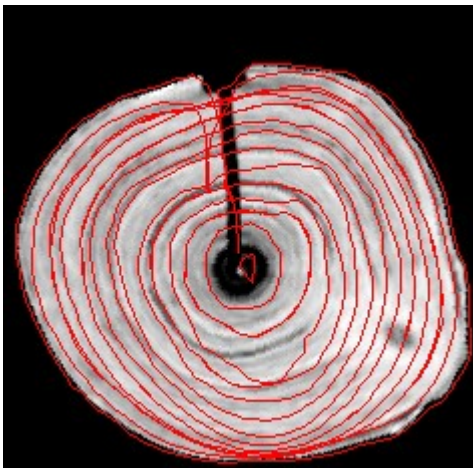
Illustration 1: Hêtre : Les cernes bruités, mais réguliers permettent un accrochage des contours actifs presque stable.
