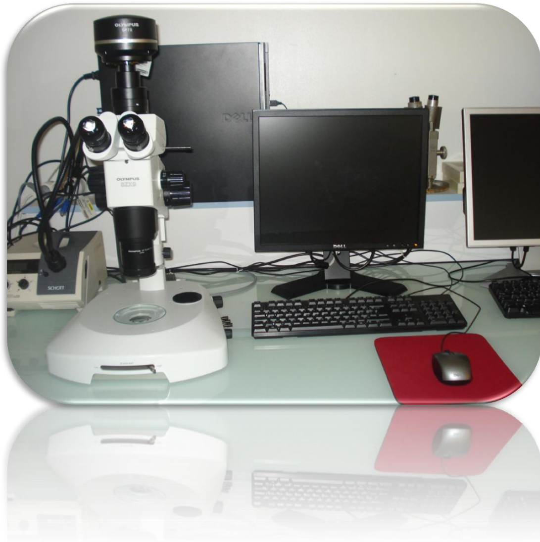
Figure 24. Microscope optique à réflexion muni de sa caméra. Equipement du CIRAD de Montpellier
