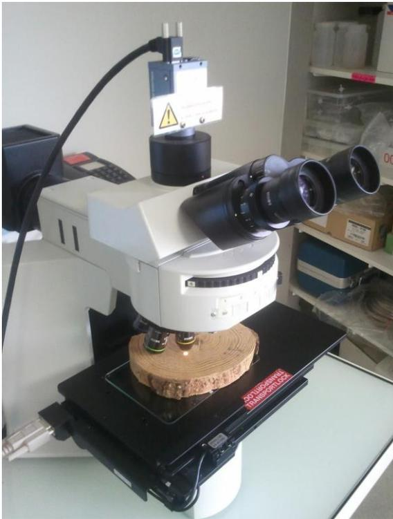
*Microscope équipé d'une platine d'acquisition*
