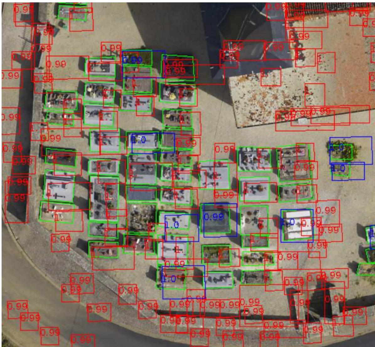
FIGURE 8.2 – Résultats de la détection par CNN sur une image de tests, les cadres représentés en vert sont la vérité terrain, en bleu les vrais positifs et en rouge les faux positifs. Les fenêtres englobantes possèdent un score qui correspond à la probabilité de contenir une tombe.
