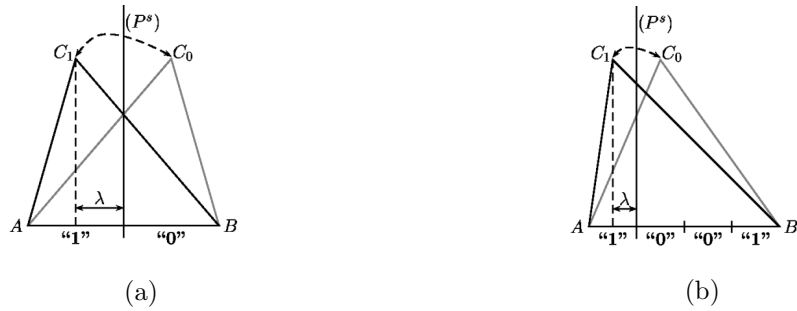
FIGURE 4.3: Méthode d'insertion de l'algorithme de Cayre et Macq [12], le bit "1" est inséré en déplaçant le sommet C_0 à la position C_1 pour que sa projection sur l'arête opposée correspondent à l'intervalle qui convient. L'arête opposée est divisée : a) en deux intervalles, b) en quatre intervalles.
