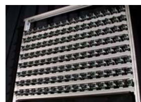
Stanford Camera Array (128 caméras)
