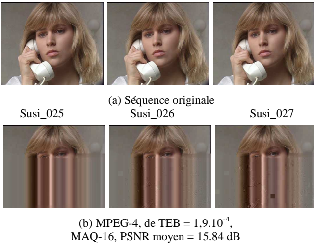
Fig. 1: Séquence transmise sur canal idéal (sans erreurs) et sur canal gaussien: (a) séquence originale (b) MPEG-4, TEB = 1,9 \cdot 10^{-4}
