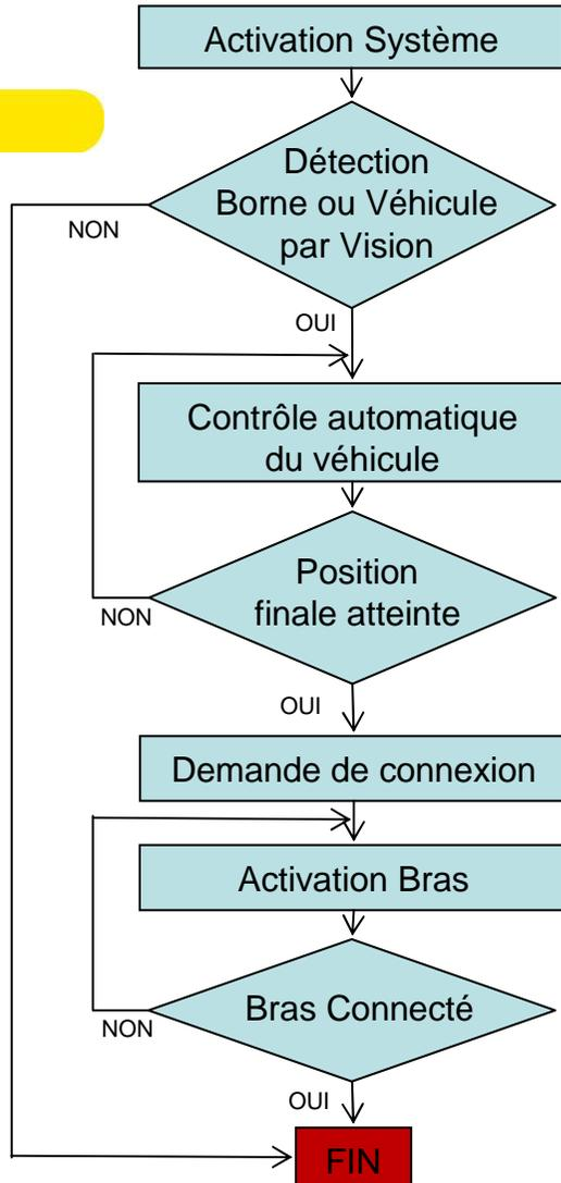
La borne est équipée d'une mire constituée de diodes infrarouges. Le véhicule, lui, est équipé d'une caméra sensible à l'infrarouge. L'algorithme de détection et d'estimation de la position 3D relative du véhicule par rapport à la borne est effectuée sur la base d'une version itérative de l'algorithme POS (Pose from Orthography and Scaling) nommée POSIT
