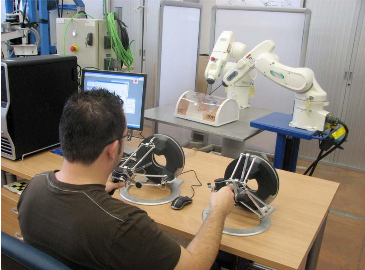
Chaque robot manipulateur est un bras Adept Viper650 à 6 degrés de liberté et équipé d'un contrôleur Cerebellum dont l'architecture ouverte nous permet de développer des fonctions de commande du robot au niveau le plus bas. Ses performances nous permettront de l'utiliser dans des applications médicales exigeantes en termes de précision et de dynamique.
