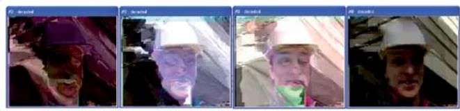
Fig. 2: Cryptage sélectif dans le codeur H.264.
