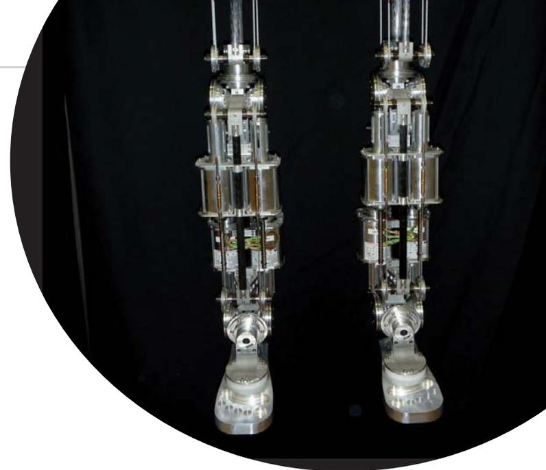
Figure 2 b) Le robot marcheur bipède Sherpa
