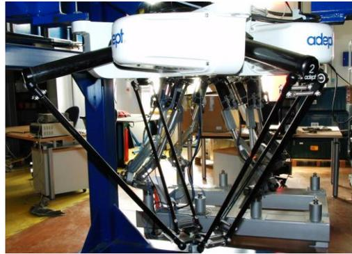
Figure R6 - Le robot Quattro commercialisé par Adept Technology
