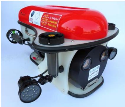
Le robot sous-marin L2ROV (k)
