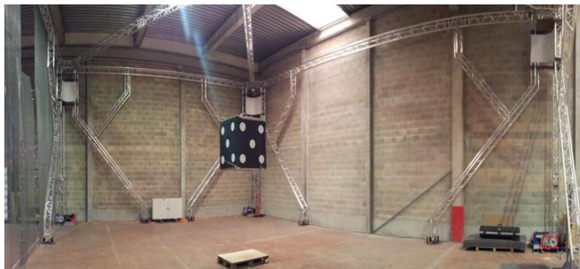
Figure R5 : Un robot à câbles de très grande dimension dans son hangar
