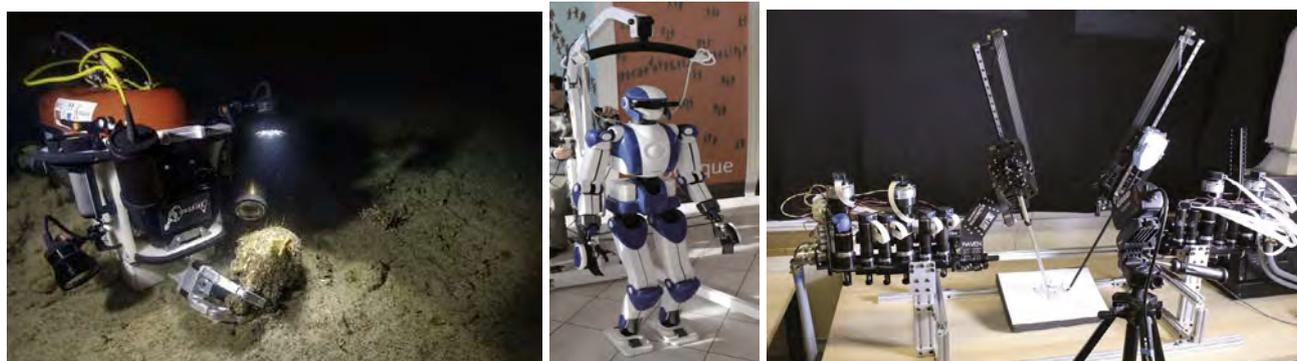
Robot sous-marin CORSAIRE. Robot Humanoïde HRP4. Plateforme de robotique médicale dédiée à la chirurgie mini-invasive RAVEN.
