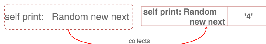
FIGURE 5.1 – Un collecteur : l'encadré en pointillé représente le point de collecte (à gauche), dont le résultat de l'évaluation (un objet) est collecté à l'exécution. Le résultat en mémoire est visible à droite : la case de gauche représente l'expression instrumentée et la case de droite la valeur collectée qui annote cette expression.
