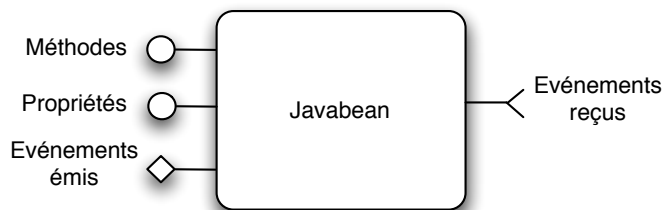
FIG. 2.9 : Structure d'un composant Javabeans
