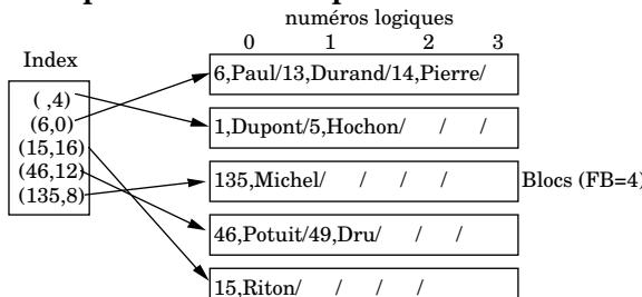
La recherche d'une clé d'un article est réalisée par dichotomie sur le fichier d'index. Lorsque le fichier atteint un volume important, son fichier d'index ne tient plus sur un seul bloc et on est alors forcé de parcourir séquentiellement les blocs d'index.
