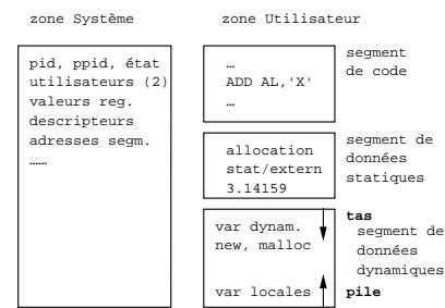
Un processus Unix réalise ses instructions normales en **mode utilisateur** puis commute en **mode système** lors d'un appel au noyau, d'une interruption, ou d'un déroutement.
