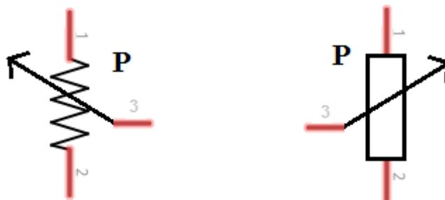
*Schéma d'un potentiomètre (convention américaine à gauche, européenne à droite)*
