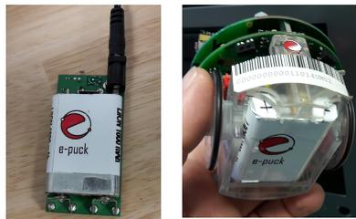
Si la LED orange sur le coté s'allume, la batterie est à changer (plus de connexion RS232 ou dans le pire de cas, plus de wifi).
