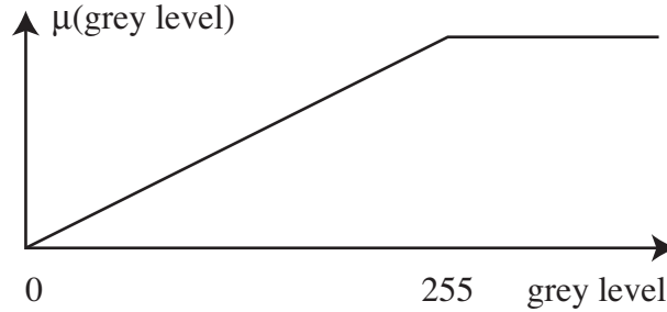
Figure 16 : association d'une fonction d'appartenance aux niveaux de gris;
